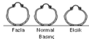
Yetersiz basınç, lastik aşımalarını hızlandırır, dönüş kabiliyetinin zayıflamasına neden olur, lastik ısınması çabuk ve hızlı gerçekleşir, yanaklarda fazla yüklenme olacağı için çatlama ve yarıklara neden olur, yetersiz basınç ayrıca yakıt tüketimini de artıracaktır.
